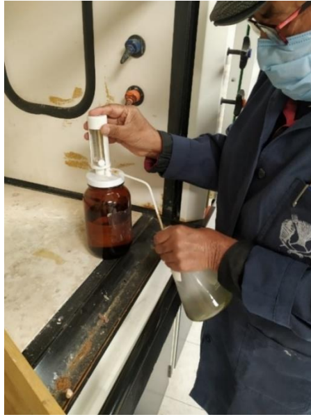
Figura 21. Agregado de ácido sulfúrico
