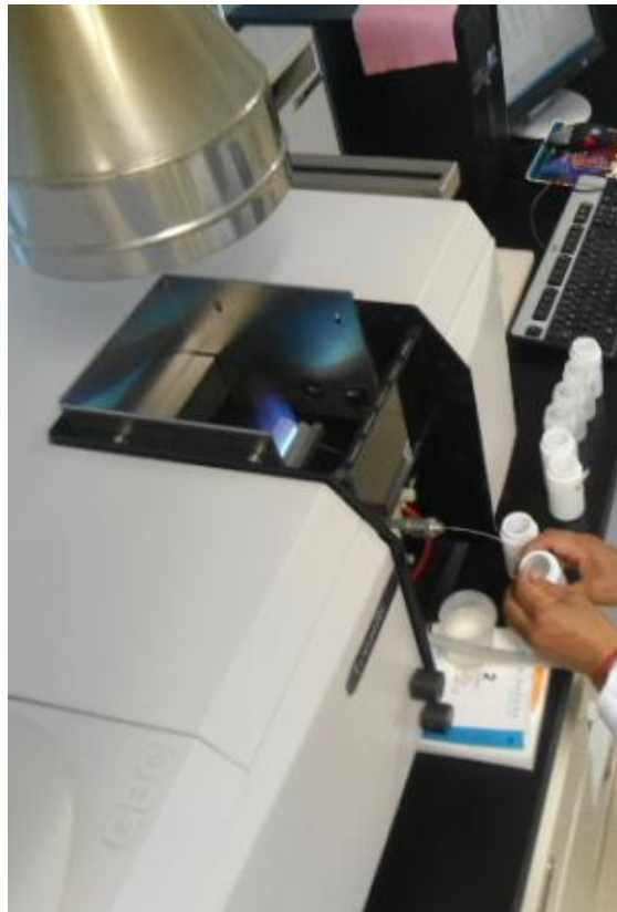
Figura IV.10. Toma de lectura con Espectrofotómetro Cintra 202 a una longitud de onda 882 nm.
