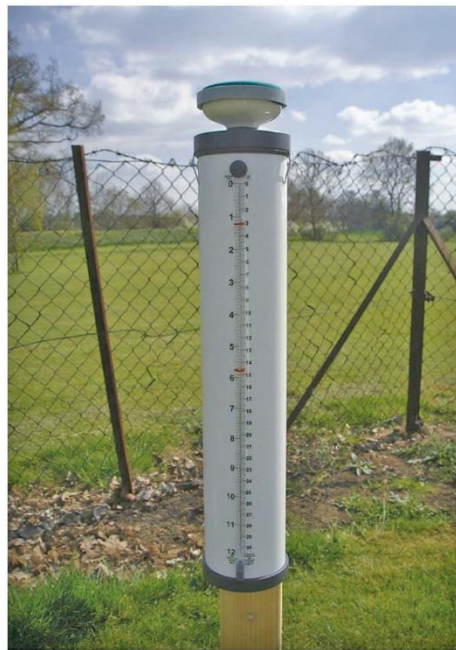
Figura 9. Atmómetro modificado (Knox et al. , 2011).
